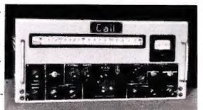
(0,5  $\mu$ V für 1 Watt NF). Mit Feineinstellung 80:1. Spiegelfrequenzsicherheit > 60 dB, im 80 m Band 85 dB. ZF-Durchschlagsfestigkeit > 80 dB. Regelbare Bandbreite von 200 Hz bis über 4 kHz. Signal-Rauschverhältnis bei 1  $\mu$ V besser als 20 dB. Mit vielen Neuerungen. DM 795.-. Prospekt anfordern.
