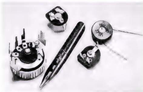
Kleinstpotentiometer der Steatit-Magnesia; links: Knopfpotentiometer Typ 51 GD mit Einschalter; oben und rechts unten: Trimmregler 57 WTD; rechts oben: Knopfregler 57 SM
